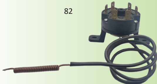
Limiteur tripolaire à réarmement manuel avec sécurité positive, plages jusqu'à 170°C, température
